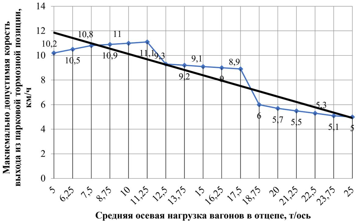
Рисунок 4.2 – Зависимость максимально допустимой скорости выхода отцепа из парковой тормозной позиции от средней осевой нагрузки вагонов в отцепе при скорости ветра  $V_B = 2,5$  м/с
