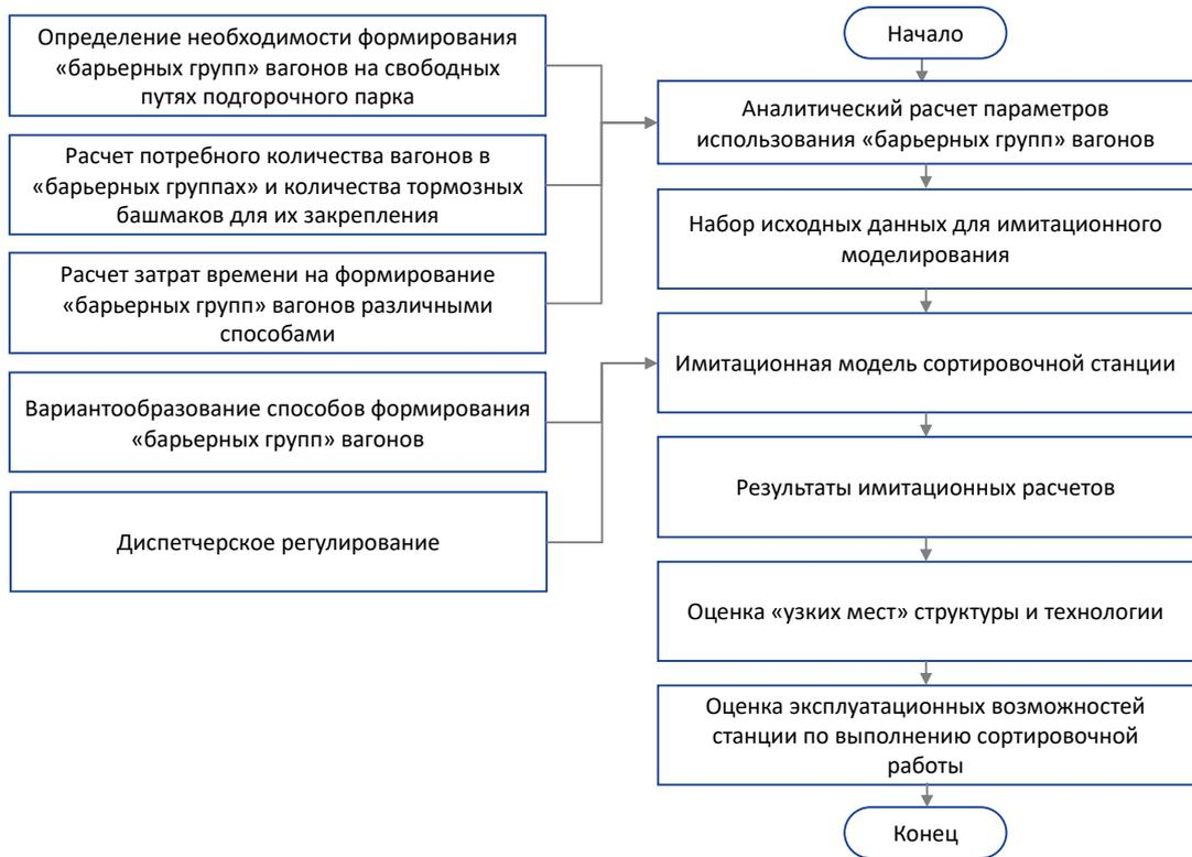
Рисунок 3.1 – Гибридная технология аналитических и имитационных расчетов
